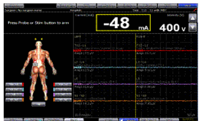
Рисунок 4 - Окно режим исследования моторного вызванного потенциала (МВП): используется для исследования двигательных путей спинного мозга
